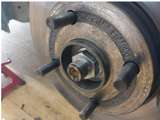
Fig.5 Stap 1: aangepaste moer eerst monteren, aanhaalmoment is 280Nm
