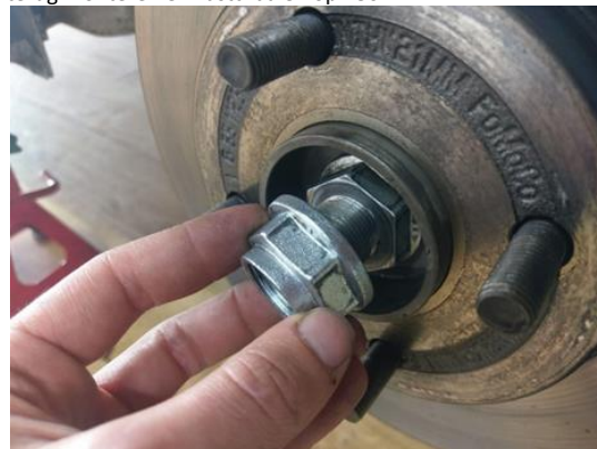
Fig.6 Stap 2: de originele (onaangepaste) moer terug monteren en vastdraaien op 180Nm.
