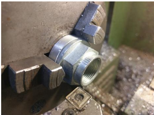
Fig.5 Stap 1: aangepaste moer eerst monteren, aanhaalmoment is 280Nm
