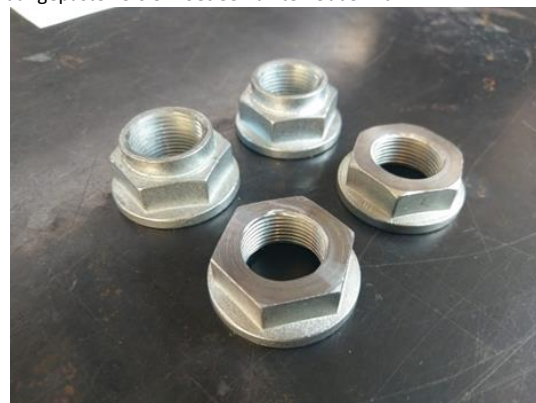
Fig.4 Verschil tussen de originele en aangepaste moeren: aangepaste versie moet een dikte hebben van 14mm.
