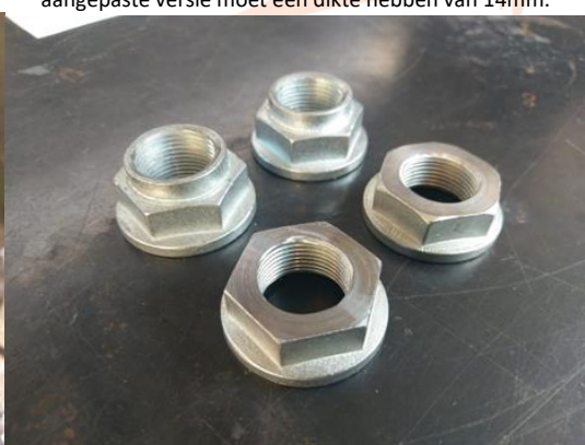
Stap 2: de originele (onaangepaste) moer terug monteren en vastdraaien op 180Nm.
