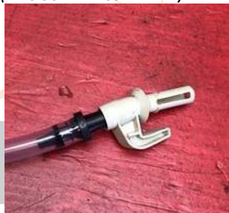
AANGEPASTE BAK ONTLUCHTER VOOR AANSLUITING SLANG. (MAG OOK VIA BUSJE IN BAK)
