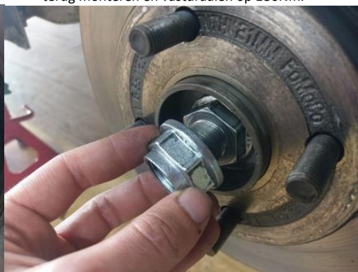
Stap 2: de originele (onaangepaste) moer terug monteren en vastdraaien op 180Nm.
