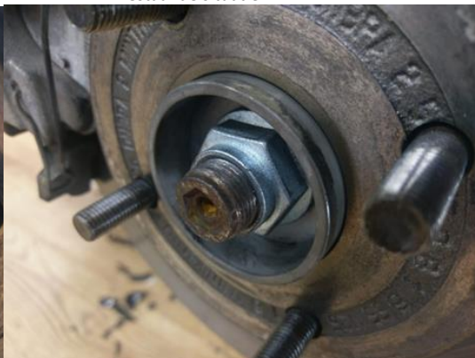
Verschil tussen de originele en aangepaste moeren: aangepaste versie moet een dikte hebben van 14mm.
